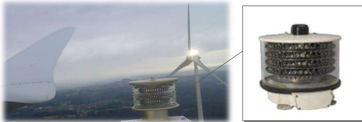
Figure 44 : Balisage d'une éolienne
